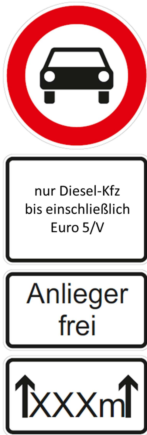
Abbildung 12: Verbot für Kraftwagen (Zeichen 251 StVO), Zusatzzeichen „nur Diesel-Kfz bis einschließlich Euro 5/V“, Anlieger frei (Zusatzzeichen 1020-30) und ein Zusatzzeichen zur Visualisierung der Länge der Verbotsstrecke
